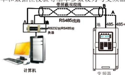
图 1 RS485 单机应用时的物理接线图
